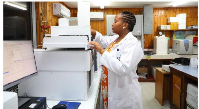
Mtaalam wa Maabara, Brina Kiwia akifanya uchunguzi wa sampuli kwa kutumia mtambo wa Gas Chromatography Mass Spectrometer (GC - MS/MS).
